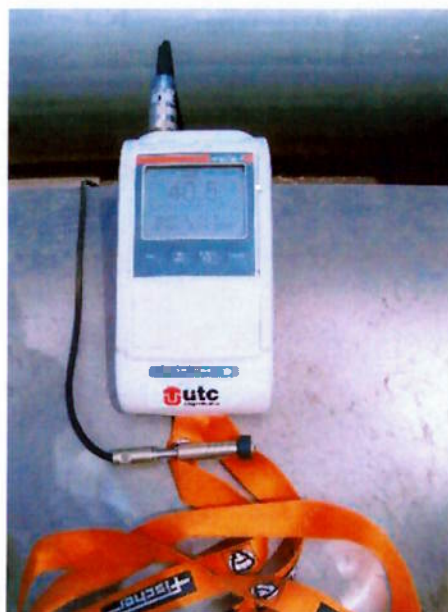
Figura 4.7 – Ferritoscópio Fischer® FMP 30.
