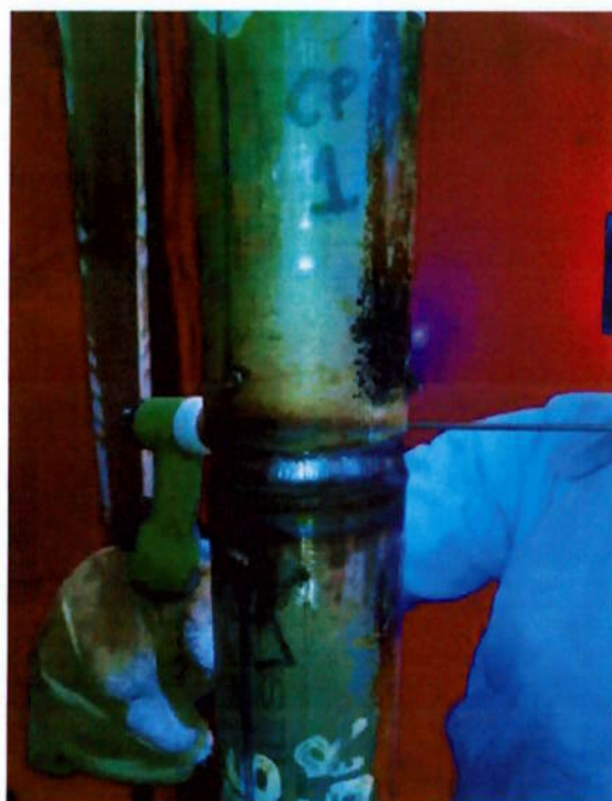
Figura 5.1 – Aspecto visual e da deposição da soldagem do CP 1.
