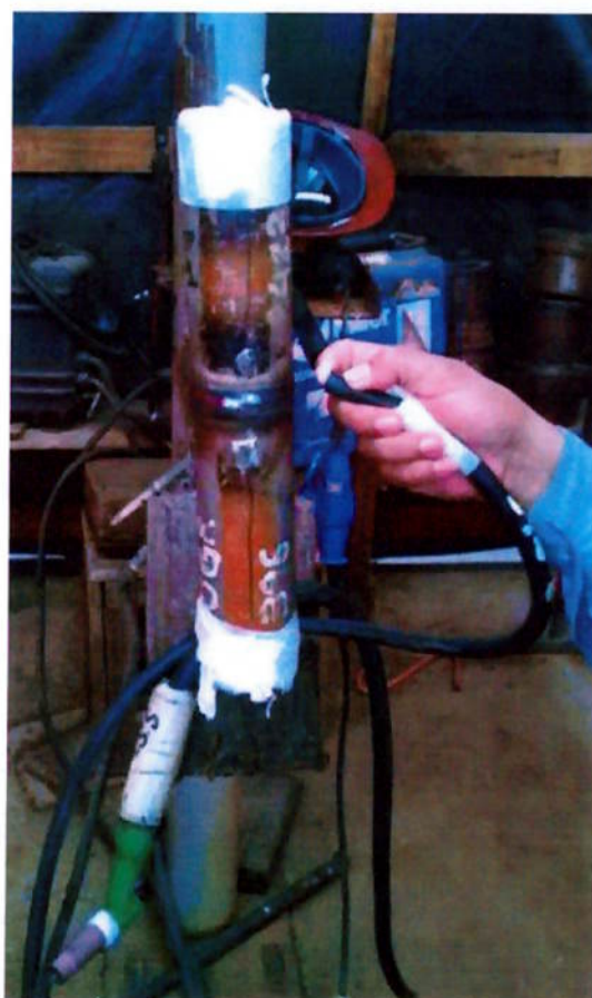
Figura 5.2 – Soldagem resfriada com jatos de argônio no CP 3.
